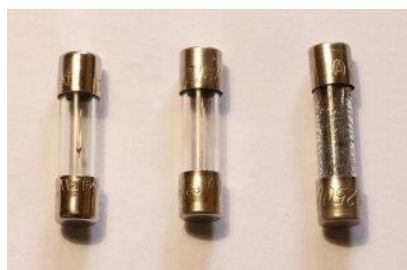
Рис. 8. Три запобіжники Ø5 × 20 мм: ліворуч – цілий; посередині – згорів помірним струмом; праворуч – згорів великим струмом
