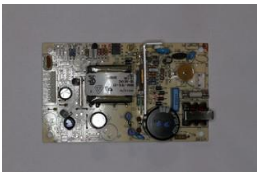
Рис. 6. SMPS без зливного резистора на конденсаторі фільтра високої напруги
