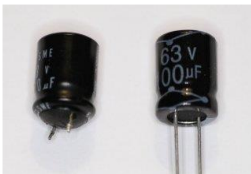
Рис. 12. Загальний вигляд електролітичних конденсаторів: ліворуч – «надутий» порівняно з новим, що праворуч
