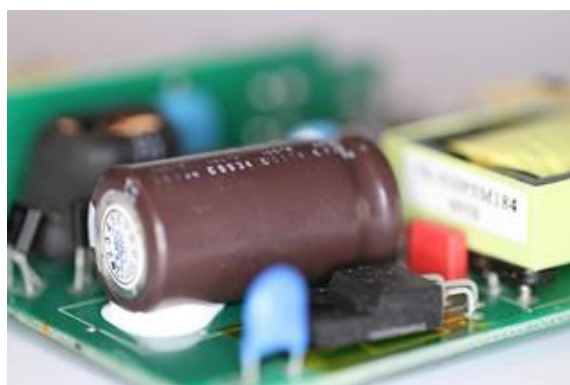
Рис. 11. Високовольтний фільтруючий конденсатор
